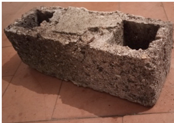
- Blocchi prefabbricati - Ampliamento 1960 -
