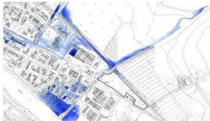
Figura 5-4: Estratto di mappa dalla Planimetria dei battenti idraulici – Involuppo Tr 200 anni
