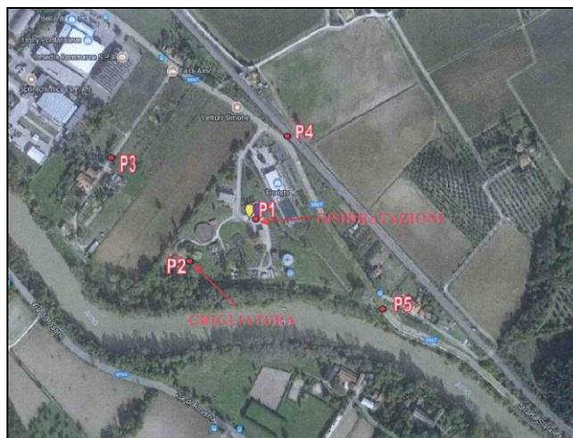
Gli esiti della campagna hanno evidenziato l'assenza di un contributo odorigeno predominante proveniente dai punti di prelievo. Nello specifico, a fronte di un livello di azione di concentrazione odorigena pari a 300 O.U.E1, i valori riscontrati sono stati di 49 O.U.E. per il punto P1, 101 O.U.E. per il punto P2, 62 O.U.E. per il punto P3, 114 O.U.E. per il punto P4 e 172 O.U.E. per il punto P5.
