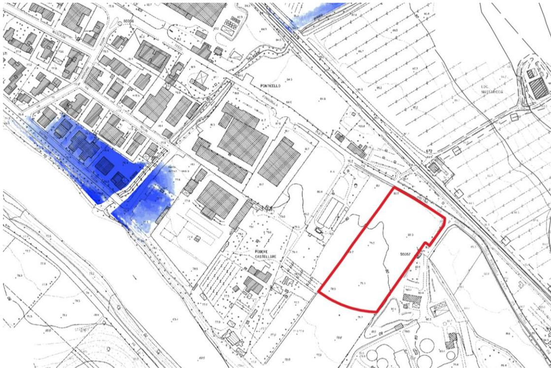
Figura 11: Estratto di mappa dalla Planimetria dei battenti idraulici – Inviluppo Tr 30 anni con evidenza dell'area di interesse
