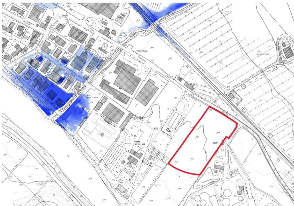
Figura 12: Estratto di mappa dalla Planimetria dei battenti idraulici – Inviluppo Tr 200 anni con evidenza dell'area di interesse
