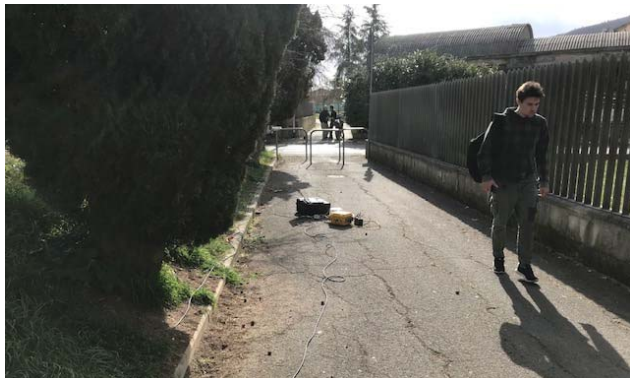
Fig. 2.1 : Operazioni di acquisizione dati rilievo sismico di superficie
