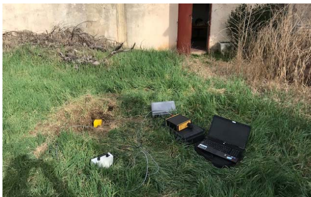
Fig. 2.2 : Operazioni di acquisizione dati per misure HVSR
